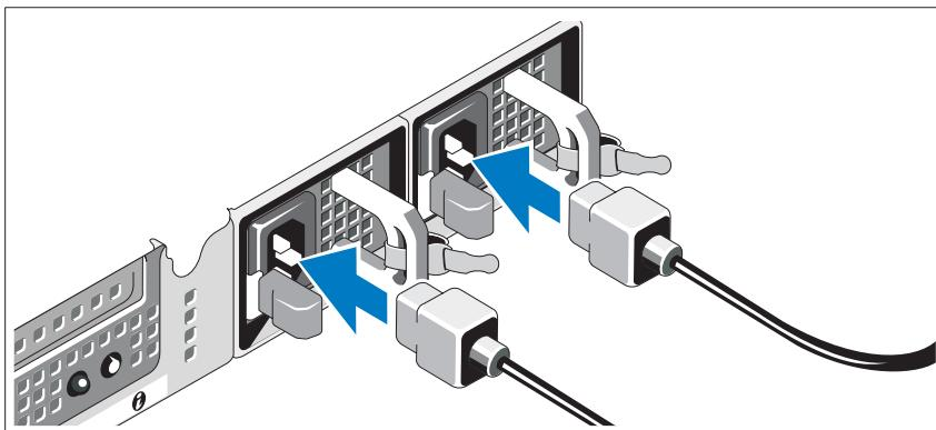
Verbinden Sie die Netzstromkabel mit dem System sowie gegebenenfalls mit dem Bildschirm.
