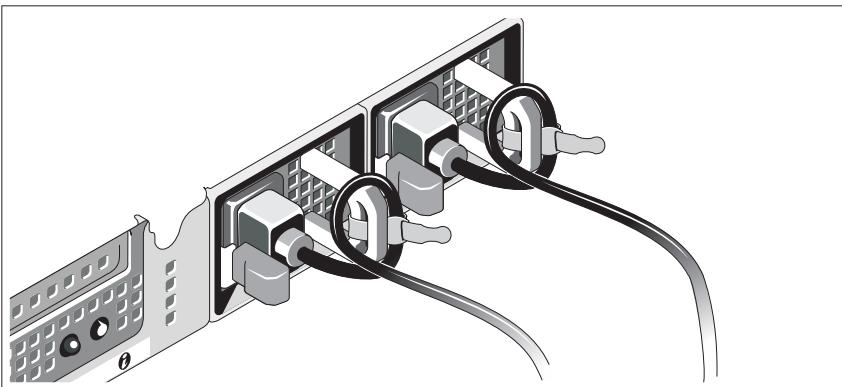
Bringen Sie die Halteklemme für das Netzkabel am rechten Bogen des Netzteilgriffs an. Biegen Sie das Netzkabel wie abgebildet zu einer Schlaufe, und befestigen Sie es an der Kabelklemme der Halteklemme.
