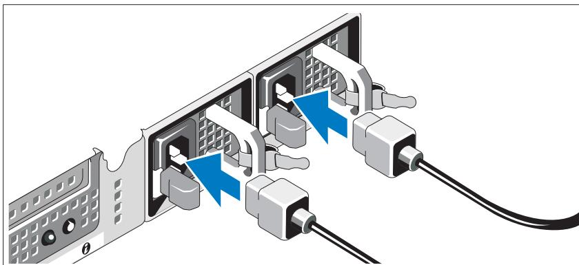
Connectez le ou les câbles d'alimentation au système et, si vous utilisez un moniteur, connectez le câble d'alimentation du moniteur à ce dernier.
