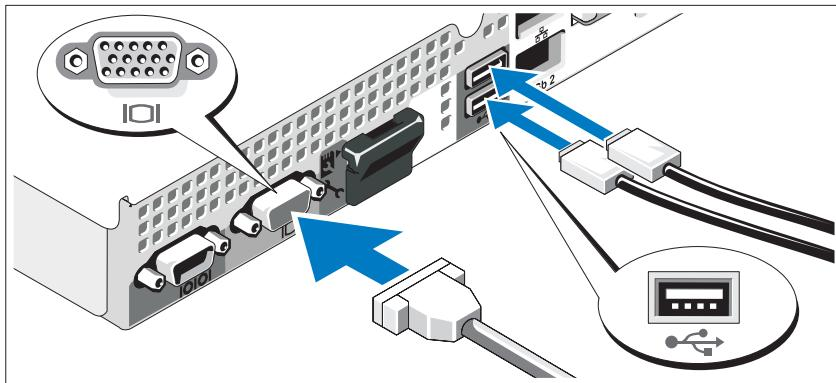
Подключите клавиатуру, мышь и монитор (дополнительно).
