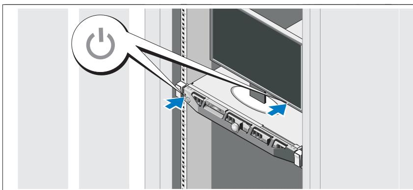
Stiskněte vypínač na systému a na monitoru. Indikátory napájení by se měly rozsvítit.
