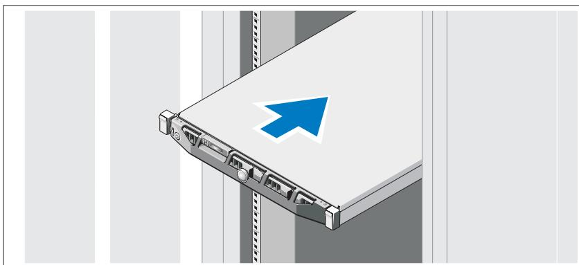
Συναρμολογήστε τις ράγες και εγκαταστήστε το σύστημα σε βάση (rack) σύμφωνα με τις οδηγίες ασφάλειας και τις οδηγίες εγκατάστασης σε βάση, που παρέχονται με το σύστημά σας.
