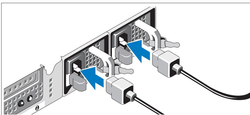
Sistemin güç kablosunun/kablolarının sisteme bağlantısını yapın ve bir monitör kullanılıyorsa, monitörün güç kablosunun monitöre bağlantısını gerçekleştirin.
