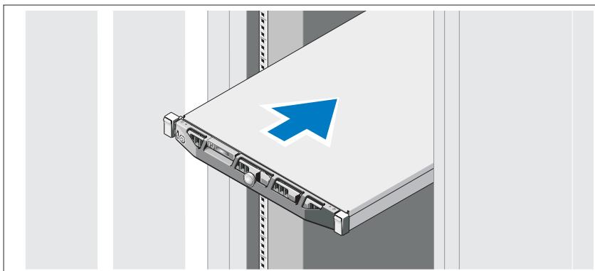
Zamontuj prowadnice i zainstaluj system w szafie typu rack zgodnie z instrukcjami dotyczącymi bezpieczeństwa oraz instrukcjami dotyczącymi montowania systemów w szafie typu rack dostarczonymi wraz z systemem.
