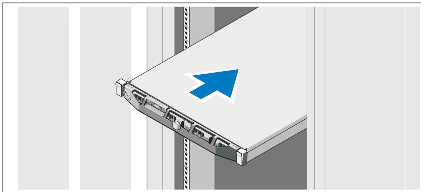
Monte los rieles e instale el sistema en el rack siguiendo las instrucciones de seguridad y de instalación del rack incluidas con el sistema.
