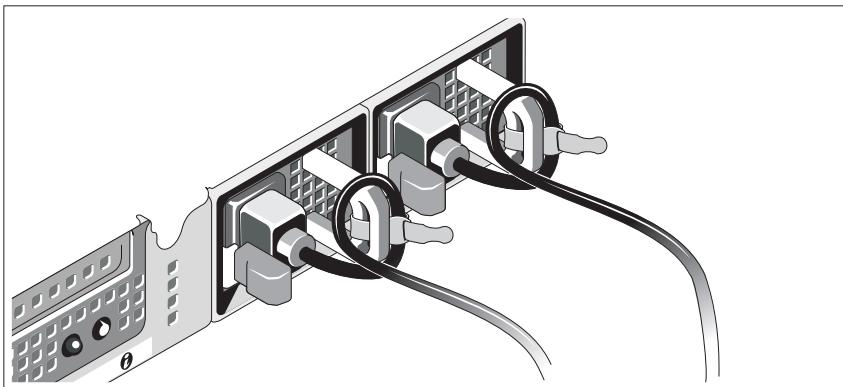
Fije el soporte de retención del cable de alimentación en el codo derecho del asa de la fuente de alimentación. Doble el cable de alimentación del sistema en forma de bucle, como se muestra en la ilustración, y fíjelo a la abrazadera correspondiente del soporte.
