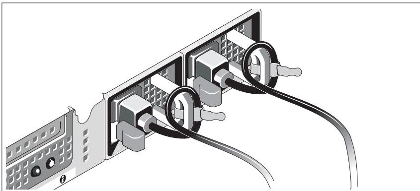
Güç kablosu sabitleme desteğini, güç kaynağı kolunun sağ kıvrımına takın. Resimde de görüldüğü gibi sistemin güç kablosunu döndürün ve kabloyu desteğin kablo kelepçesine takın.
