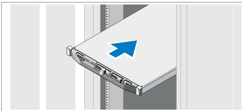
Sestavte kolejničky a nainstalujte systém do stojanu podle bezpečnostních pokynů a pokynů k instalaci do stojanu dodaných se systémem.
